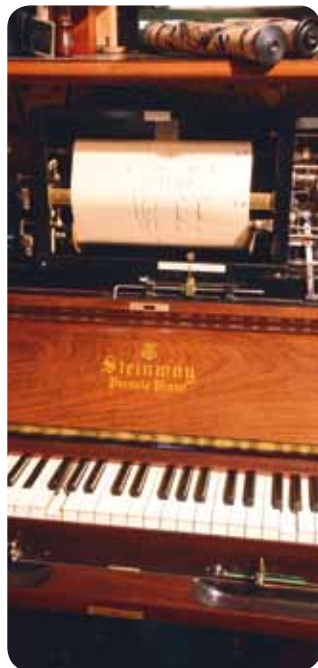
Un piano mécanique Steinway avec sa réserve de rouleaux. 88 touches et donc 88 trous sur la mécanique accueillant le rouleau perforé. Lorsqu'une perforation est alignée avec un trou, de l'air passe et active la touche, et donc la note. C'est en activant les pédales que l'on fournit le « vent » nécessaire à l'instrument. Une turbine à air a ensuite été ajoutée, ce qui permet à l'utilisateur de ne plus... pédaler.
