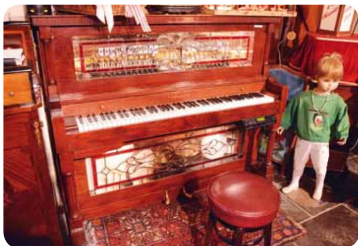
Ce bastringue datant de la fin du siècle dernier est constitué d'un groupe de 14 instruments de musique, dont bien sûr un piano. Il était principalement utilisé dans des cafés et autres bals populaires. Un cylindre comporte 10 airs et fonctionne au moyen d'un monnayeur. Cet orchestron, très populaire au début du siècle, a connu son déclin à l'apparition des bandes perforées (limonaire) remplaçant les cylindres. Cet exemplaire est le seul connu en Europe en état de fonctionnement.
